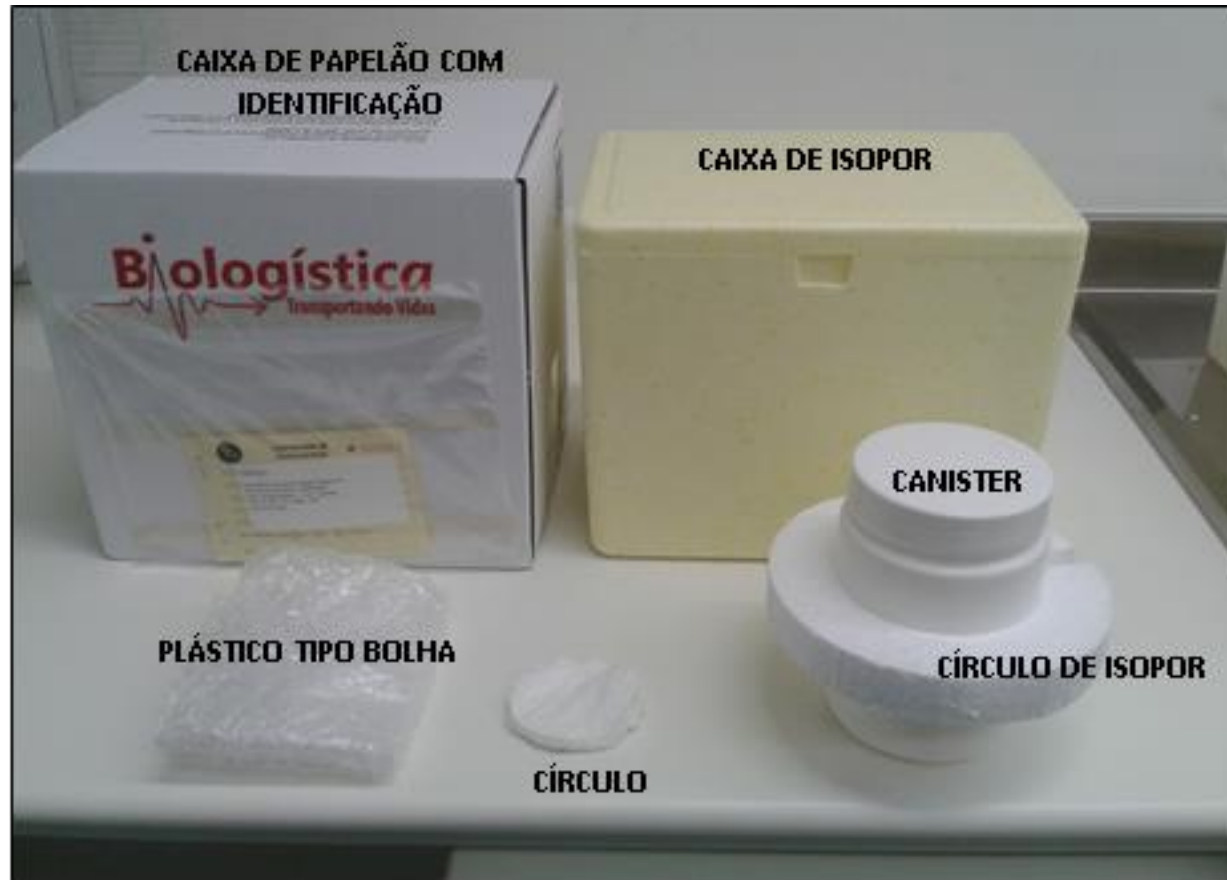
Figura – Caixa para envio dos painéis. Componentes da caixa: isopor, canister, círculo de isopor, círculo de isopor e plástico bolha.
